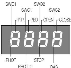
Con cada entrada está asociado un segmento del display que, en caso de activación, se enciende, según el esquema siguiente.
