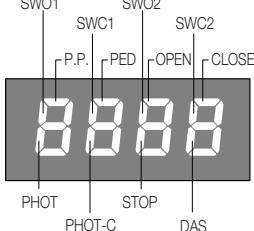
Jedem Eingang ist ein Displaysegment zugeteilt, das bei der Aktivierung laut nachstehendem Schema aufleuchtet
